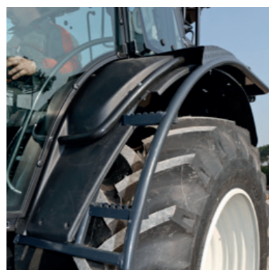
Aufstiegsleiter, im Kotflügel vom Traktor eingliedert. Echallier d'accès intégré dans le garde-boue du tracteur.
