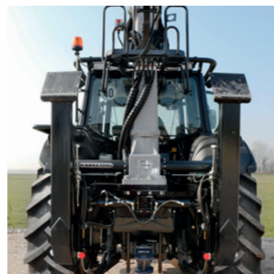
Hinteransicht mit Ausstattung und Bügeln mod. ICAR und Schwenkstabilisator. Vue arrière avec la préparation et de serrage mod. ICAR et stabilisateurs orientable.
