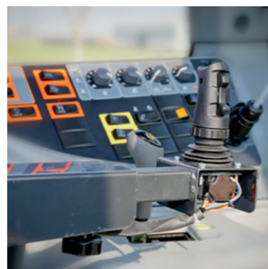
Innenkabine-Steuerung mit vierachsigem Steuerknüppel Parker mit programmierbarer Steuerung. Commandes intérieur de la cabine avec joystick Parker 4 et avec unité de commande programmable.
