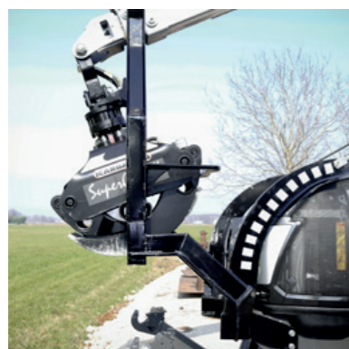
Vordere Auflage mit Arm in Ruhelage während Transport. Support de devant avec bras à repos pendant le transport.
