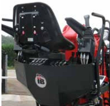
Bequeme und ergonomische Kontrollstation mit Cloche-Hebel und Fußschaltung. Sicherheitschutz für Bedienungshebel. Poste de conduite avec distributeur assisté et Joysticks servohydrauliques.
