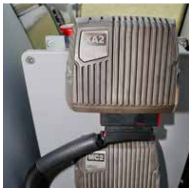
Elektronische Steuerung von Parker oder Danfoss, die programmierbar für die Verwaltung der Programmen ist. Unité de contrôle électrique Parker ou Danfoss programmable pour la gestion complète des commandes.
