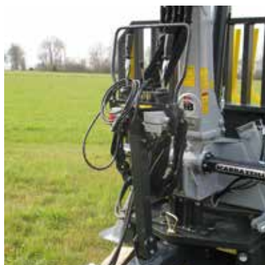
Führersitz am Boden mit elektro-hydraulischem Verteiler. Poste de conduite au sol avec distributeur électrohydraulique.
