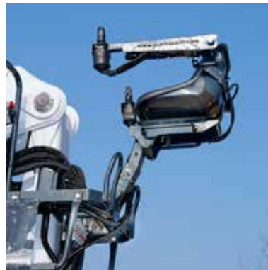
Leitstelle mit proportionalen Steuerknüppel von Parker oder Danfoss für äußeren Zusammenbau, und Schirmung gegen Überlagerungen. Poste de commande avec Joysticks proportionnels Parker ou Danfoss pour montage extérieur et blindage contre interférences
