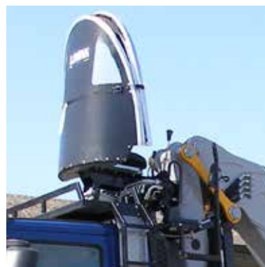
Leitstelle mit Schutzhaube. Poste de commande avec capot de protection.
